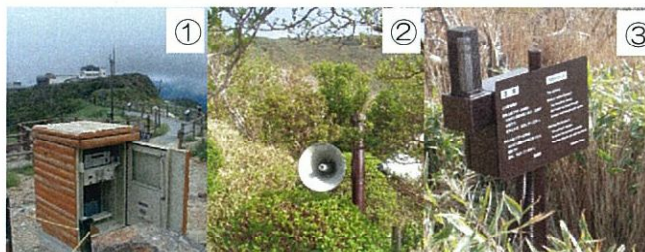
①火山ガス自動測定器②警戒濃度に達した時に4ヶ国語の警戒アナウンスが流れる自動放送システム③警戒濃度に達すると点滅して知らせるシグナル灯
